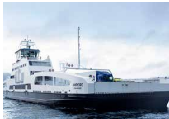
«Ampere» er verdens første bil- og passasjerferge som går på batteri. Den går i trafikk i Sognefjorden. Båten drives av Siemens-teknologi. Foto: Siemens
